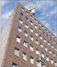
モノトーンを基調とした外壁には、汚れにも配慮した光触媒をコーティング
