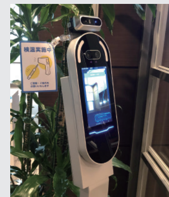
検温サーモモニター設置 (資産運用会社出入口)
