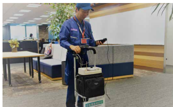
定期的な室内空気環境調査
