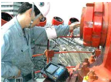
(主軸超音波探傷)
